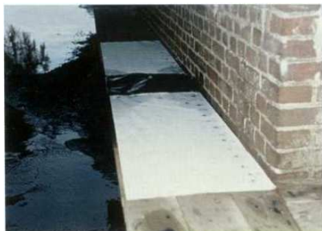
Ryc.17.2.1a. Monitoring skuteczności przejścia dla małych zwierząt – stosowanie płacht papieru i kuwet z tuszem.
