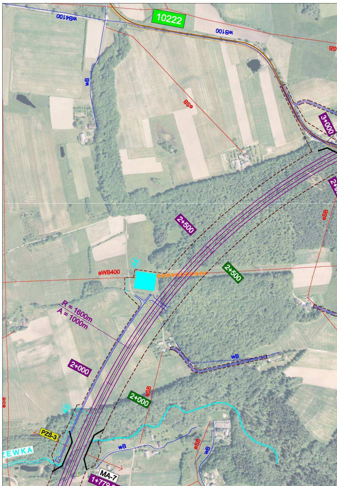
Rysunek 6.8. 10 Miejsce kolizji projektowanej drogi z siecią elektroenergetyczną wysokiego napięcia – Wariantach A, A1, A2 i B4 – km 2+394.
