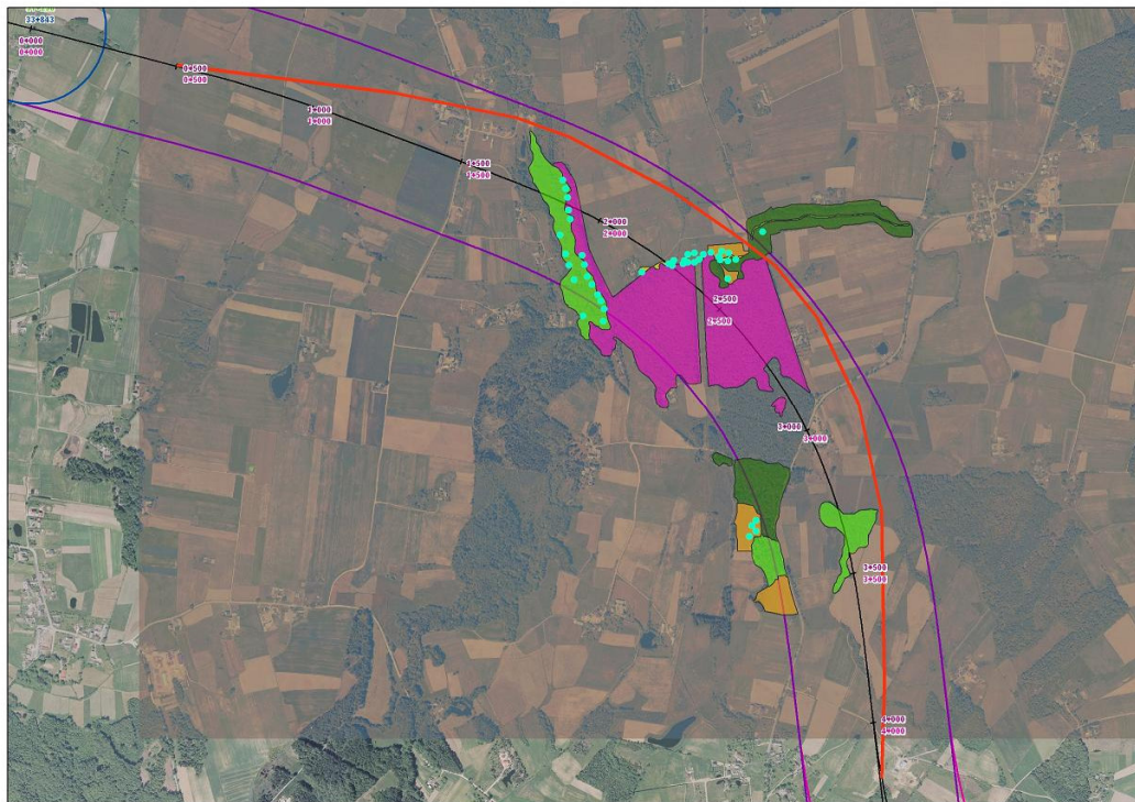
Rys. 3. Proponowana korekta przebiegu drogi S6 według wspólnego przebiegu wariantów grupy A oraz grupy B i C
